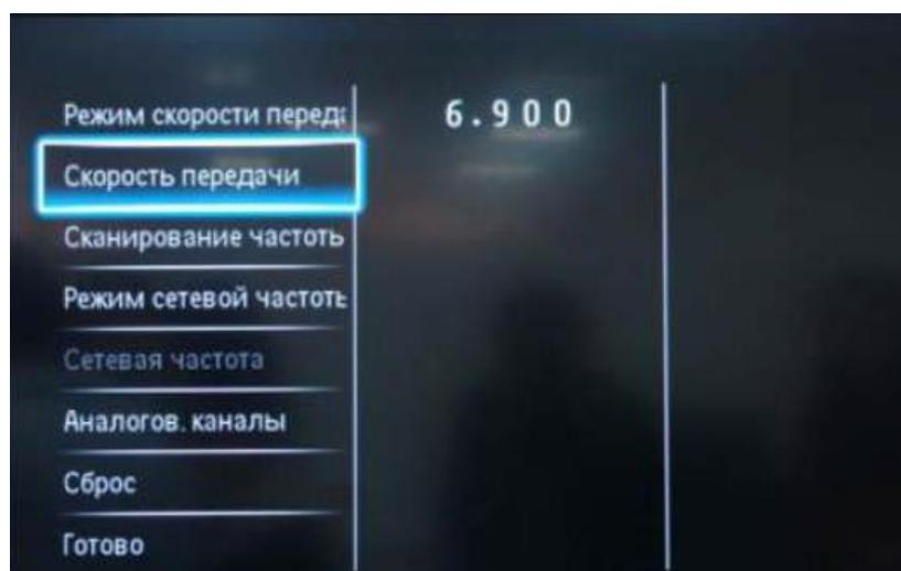
8. Установите ручной режим сетевой частоты и с пульта управления введите сетевую частоту **410.00**.
