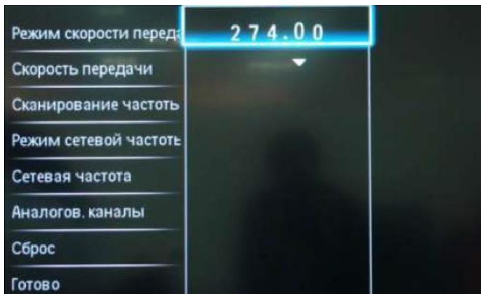
9. После нажатия вкладки «Готово», вы опять попадете в меню запуска каналов. Теперь можно начать сканирование.
